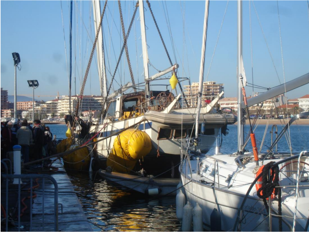
Décembre 2008 : le voilier motorisé Vent du Large , en provenance de Grande-Bretagne, coule après avoir été drossé sur la jetée par mauvais temps. Ici, il est en cours de renflouement.
