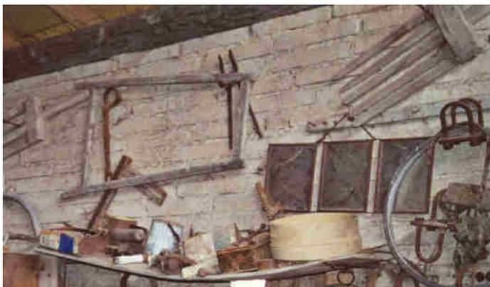
déposée et appliquée sur une forme. Le petit côté le plus large de ce moule en bois semi tronconique est prolongé d'un manche. La tuile fraîche bien calée sur ses longs côtés, le moule est rapidement retiré pour servir à la prochaine. Au XVI<sup>e</sup> siècle, le même type de gabarit trapézoïdal sert aussi à préparer la galette destinée aux tuiles plates à
