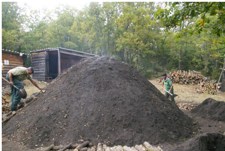
Fig. 5 : meule prête pour la cuisson du charbon
