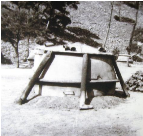
Fours de carbonisation du bois utilisés au Gratadis en 1941 par les chantiers de la jeunesse
